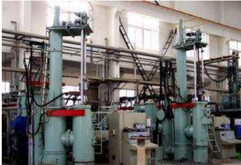
图 4.2-4 同类型真空自耗炉结构图片
