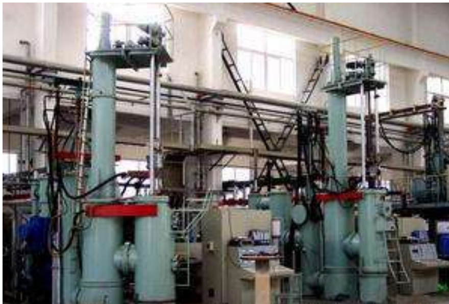
图 3.5-7 同类型真空自耗炉结构图片
