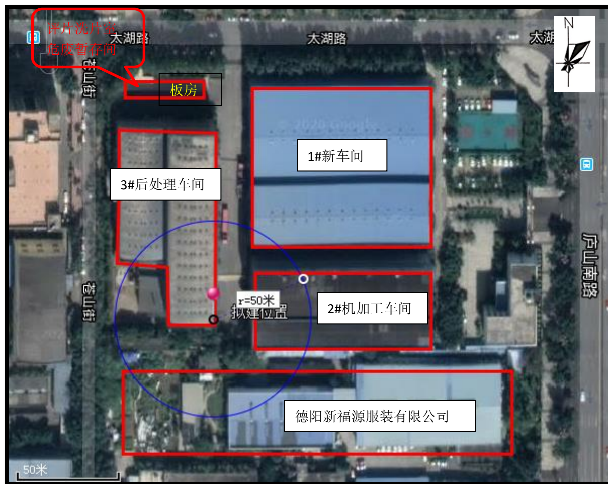
图 1-2 工业 X 射线探伤房新建项目与周边关系图
