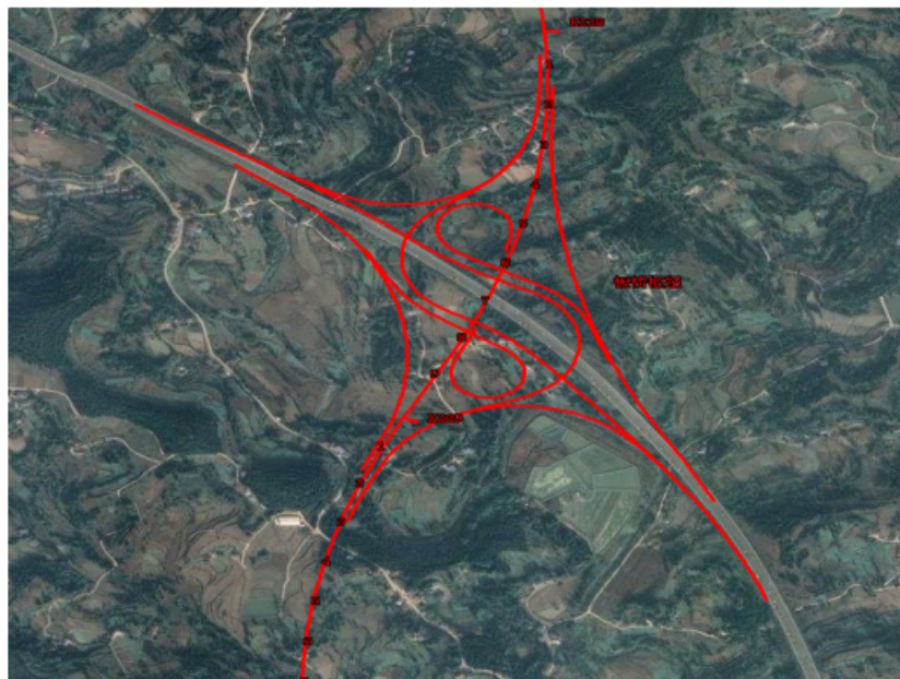
图 2.8-13 板桥枢纽互通平面图
