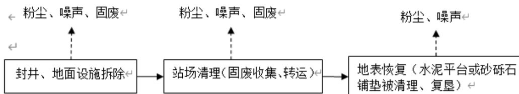
图 4.3-1 退役期施工工艺流程图
