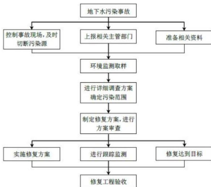
图7.6-3地下水污染应急治理程序
