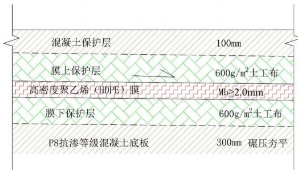
图7.6-1重点防渗区推荐防渗结构图
