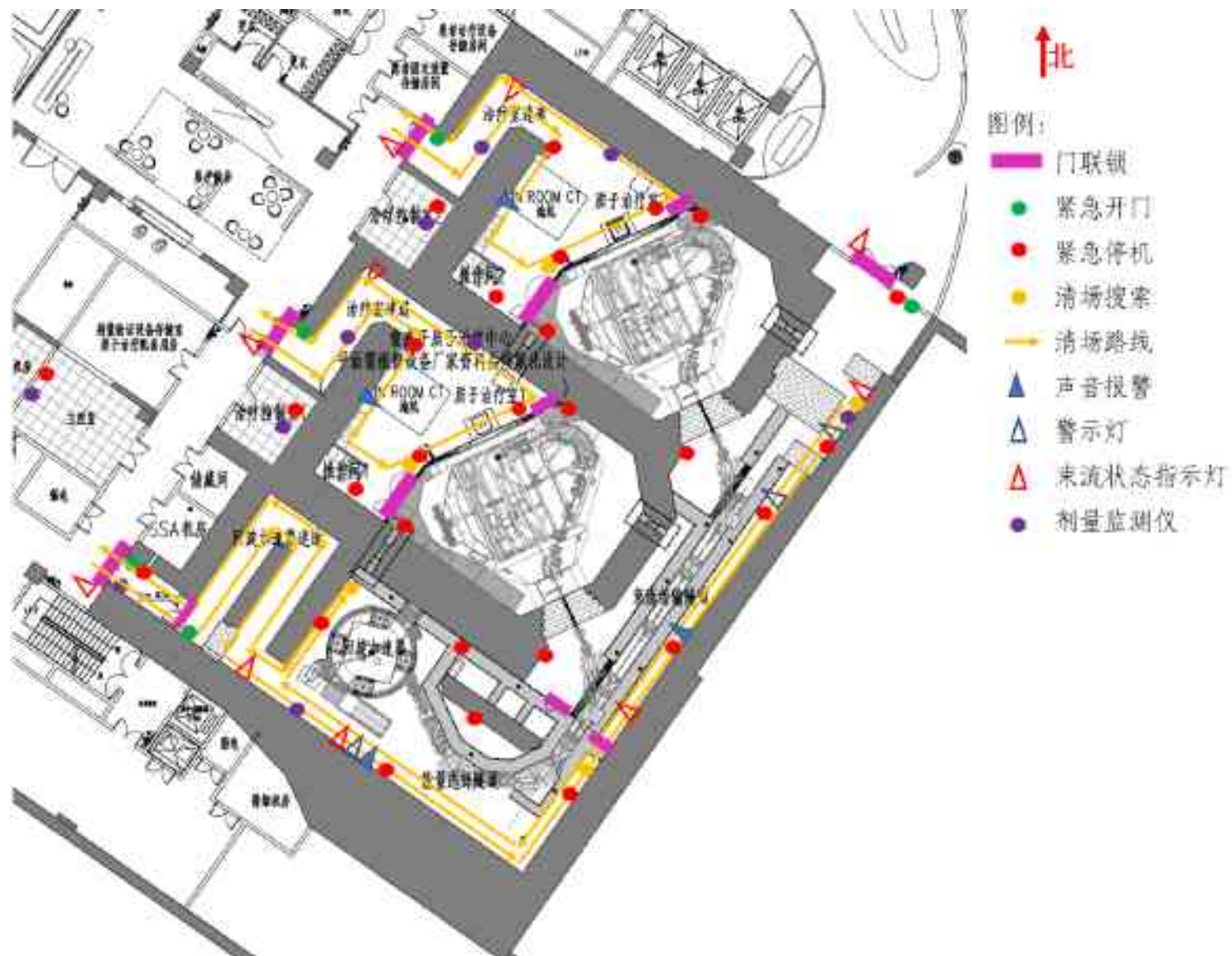
图 4-8 质子治疗系统安全联锁设施分布点位及清场搜索路线示意图（地下二层）
