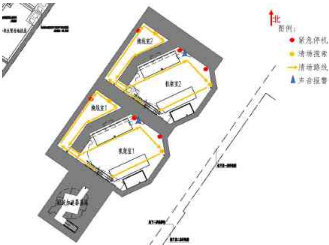
图 4-9 质子治疗系统安全联锁设施分布点位及清场搜索路线示意图（地下三层）
