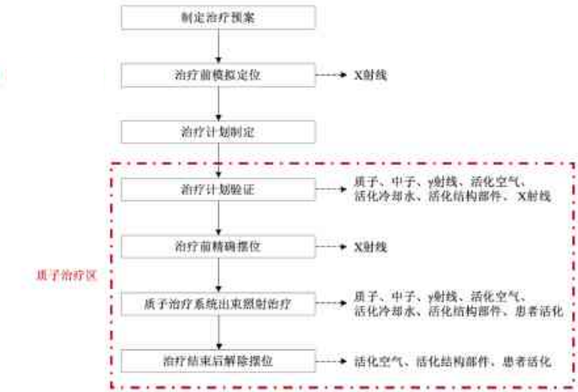
图 3-26 质子治疗系统工作流程及主要产污环节图
