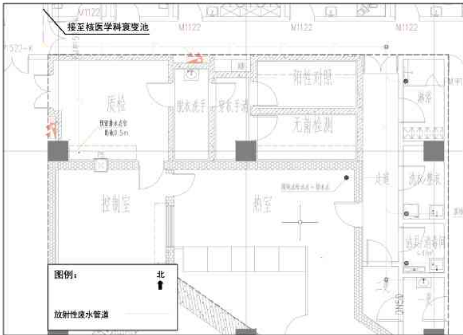
图 4-45 PET 药物制备区放射性废液管道示意图
