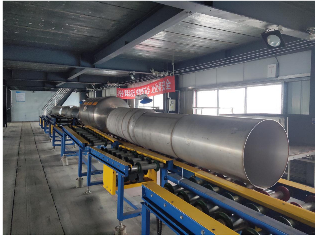
图 9-6 探伤工件实景图
