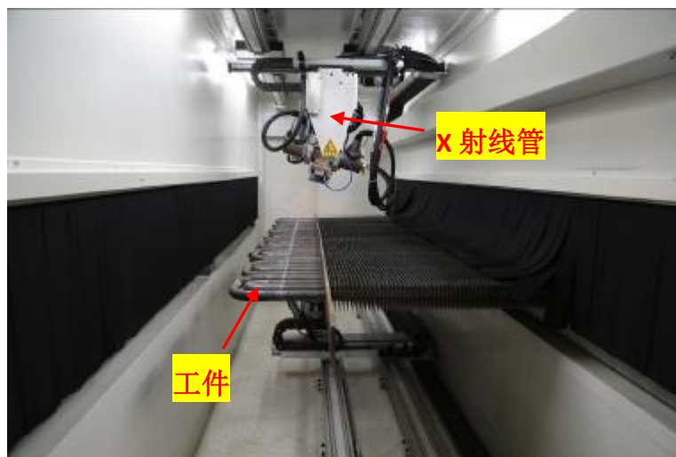
图 9-9 同类型管屏 X 射线数字成像系统铅房内实景图
