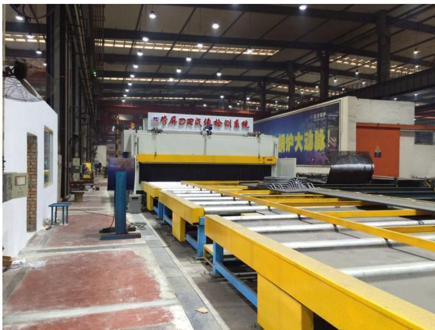
图 9-8 同类型管屏 X 射线数字成像系统实景图
