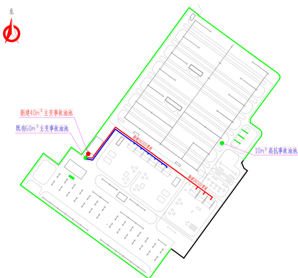
图 3-3 本工程设计阶段已采取事故油收集措施
