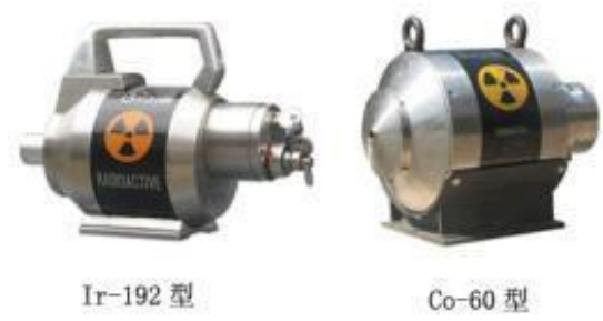
图 9-8 \gamma 射线探伤机外观图
