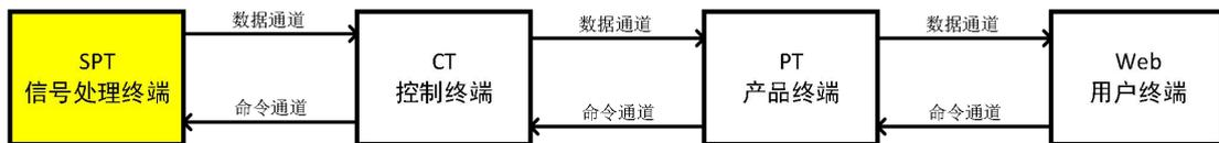
图 3.2-2 雷达终端软件系统结构
