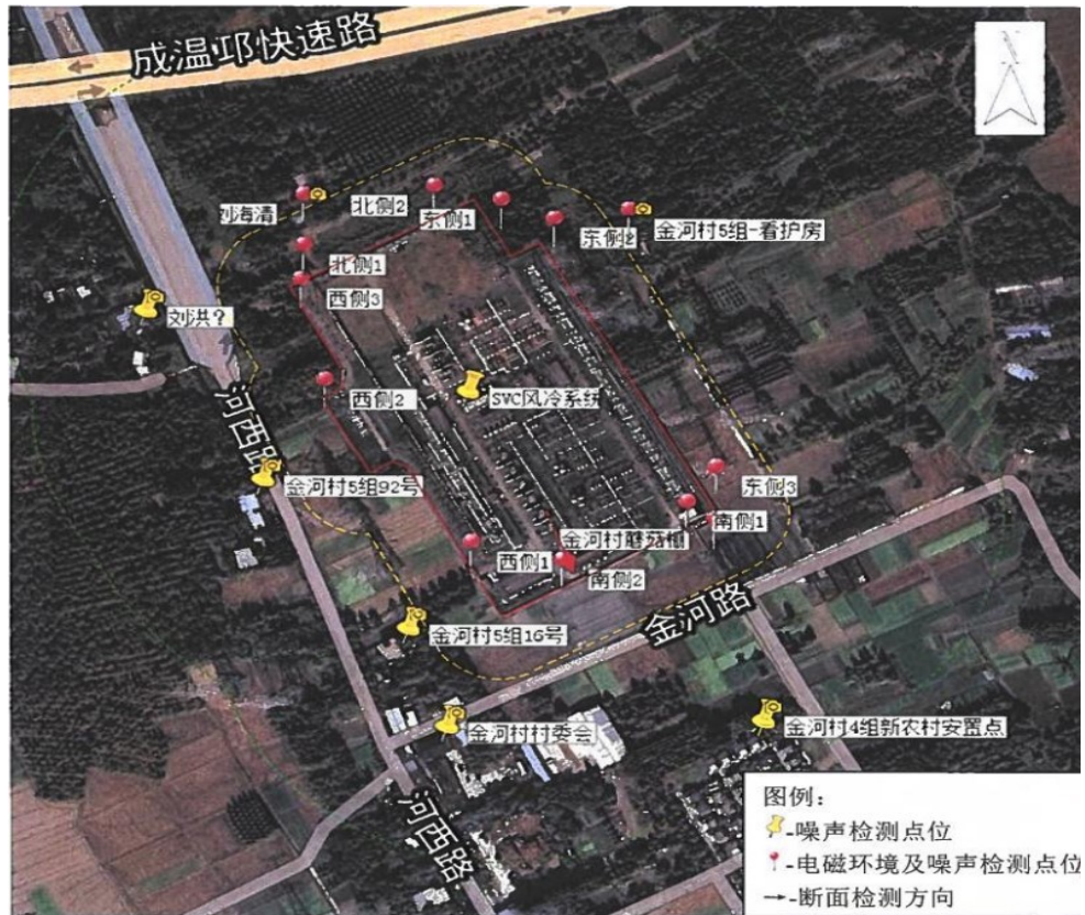
图 6-1 类比变电站的监测布点情况
