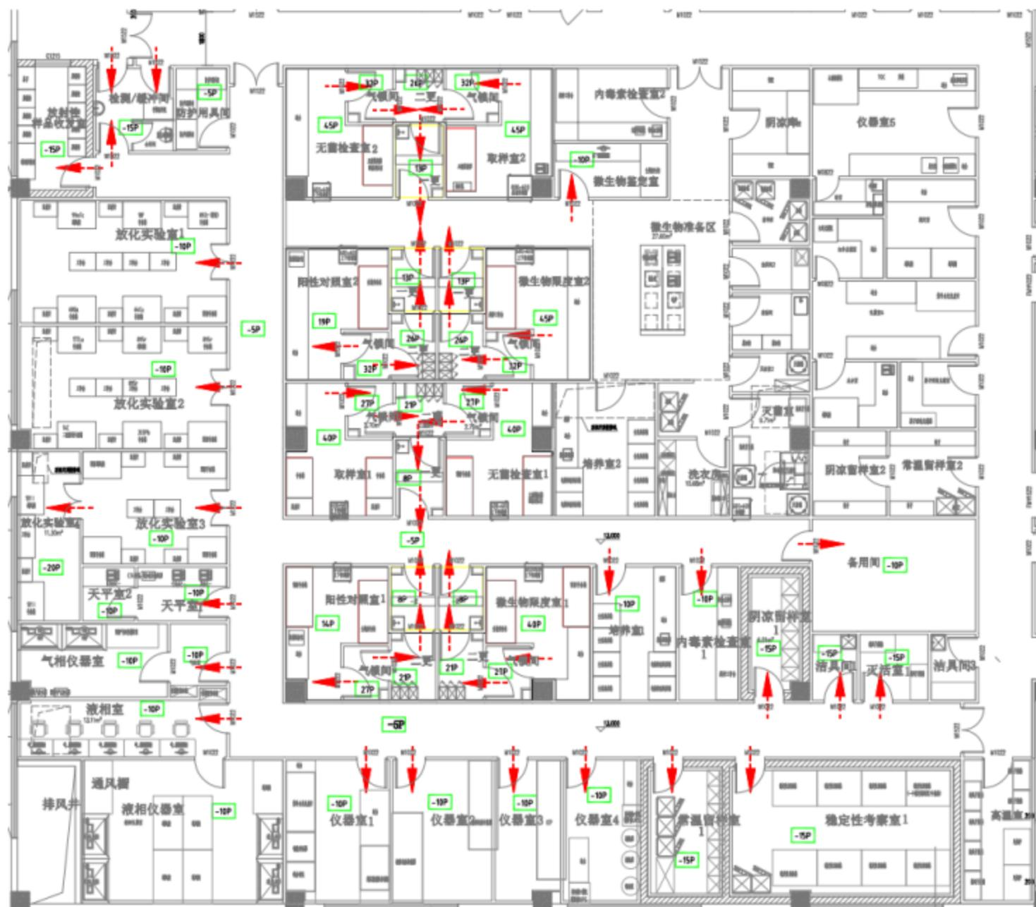
图4.2.2-3 2号楼三层非密封放射性物质工作场所压差分区及气流组织图
