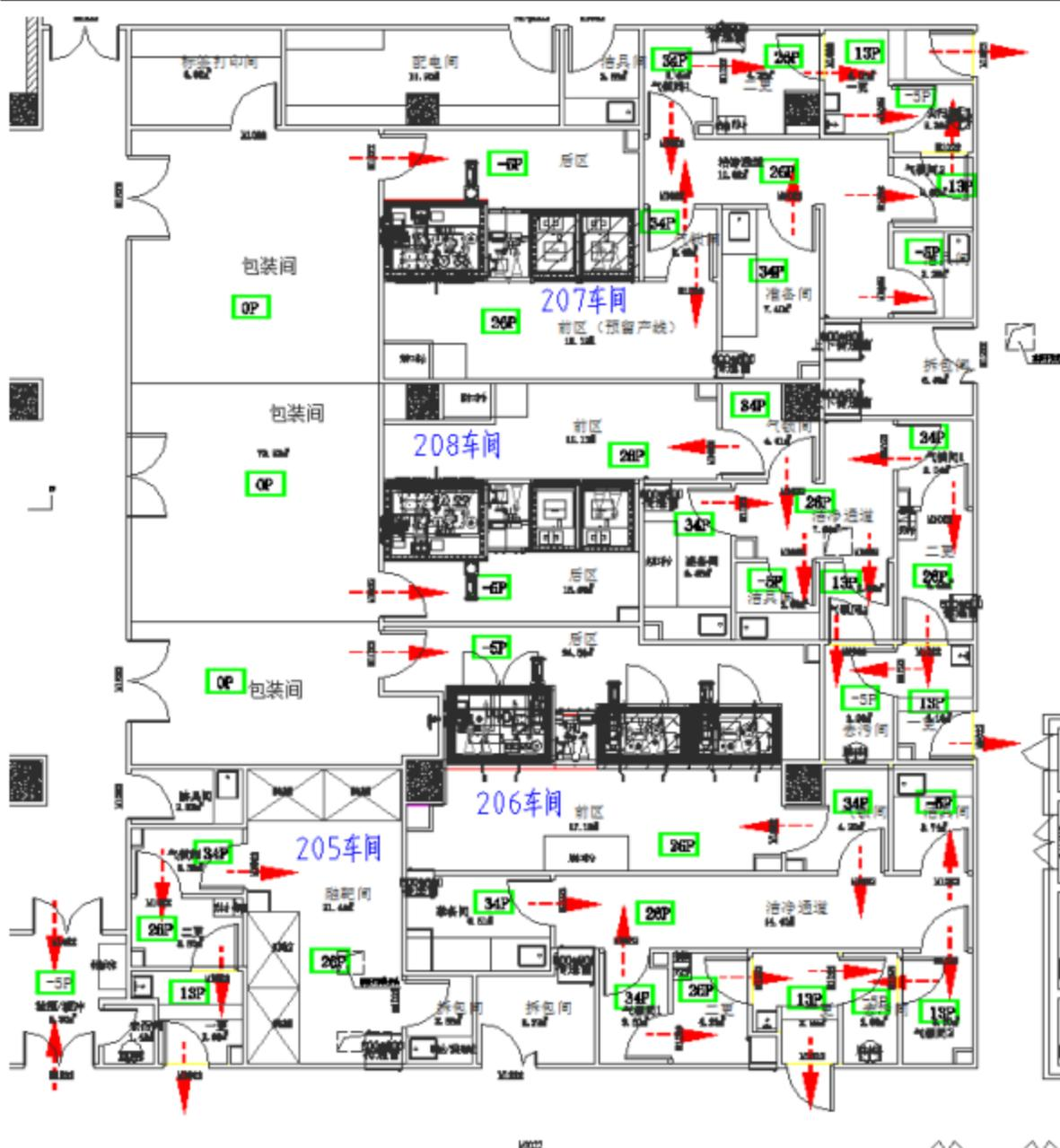
图4.2.2-1 2号楼一层非密封放射性物质工作场所压差分区及气流组织图
