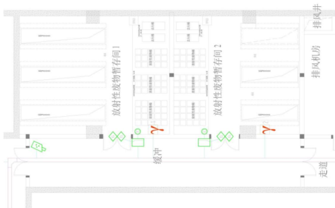
放射性废物间监控和固定式 $\gamma$ 监测仪布置
