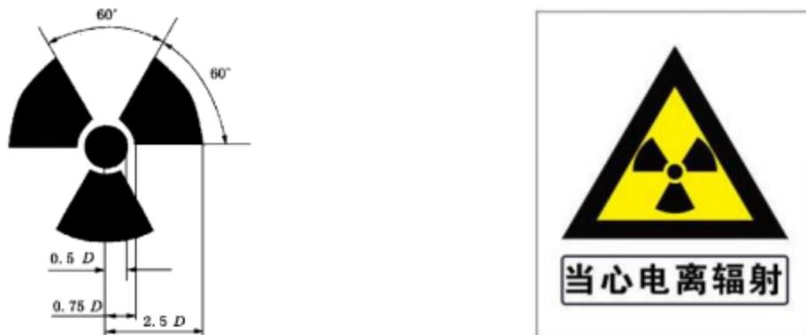
图4.1.2-1 电离辐射标识和电离辐射警告标识
