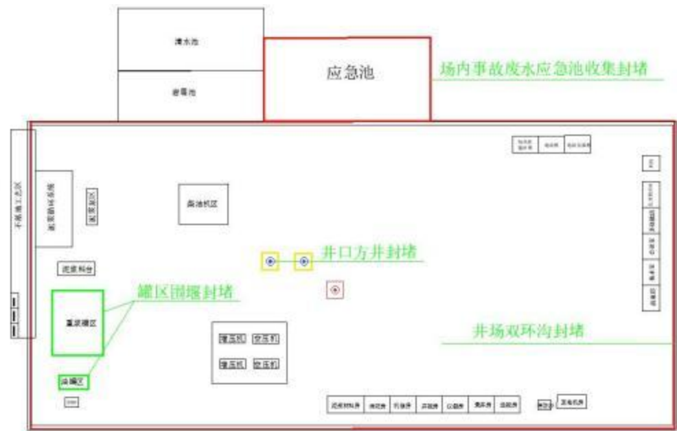
图 8.10-1 施工期防止场内事故废水进入外环境的控制、封堵措施
