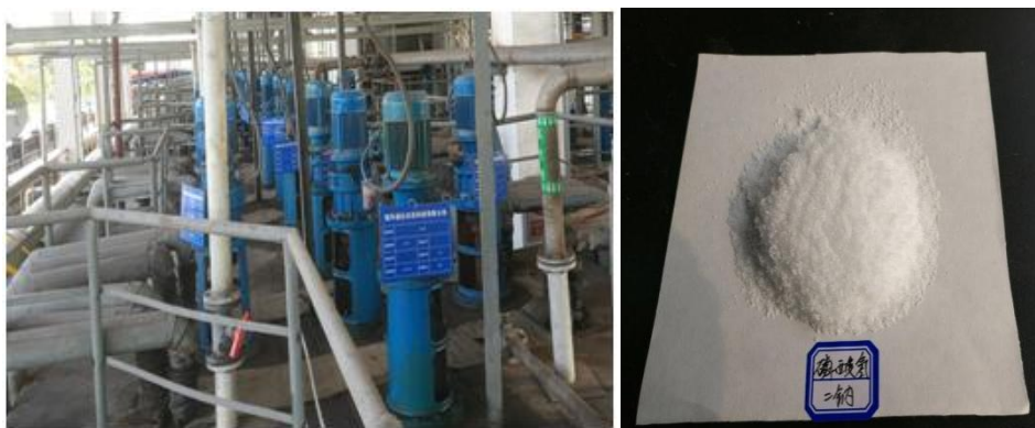
图 3-11 磷酸氢二钠回收装置及产品
