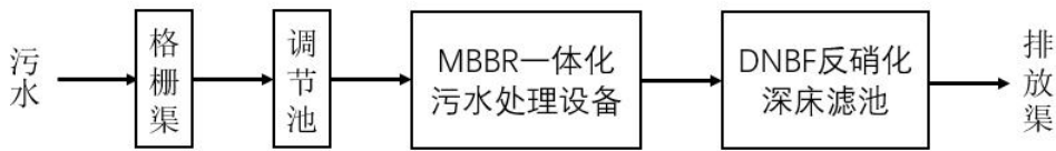
图 2-11 MBBR+DNBF 工艺流程图
