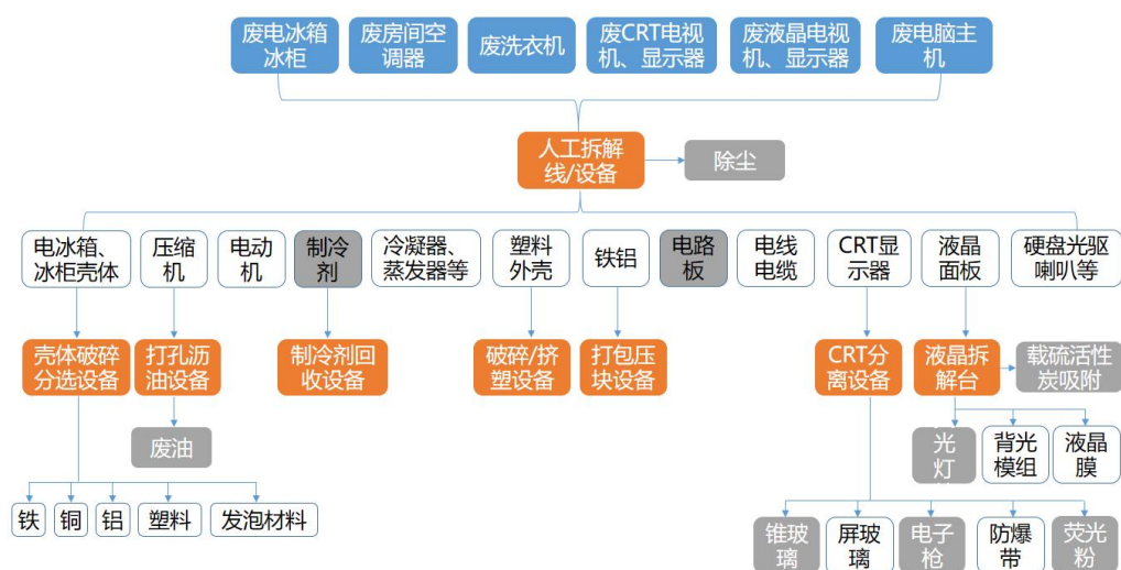
图 6-4 废旧家电拆解工艺流程图
