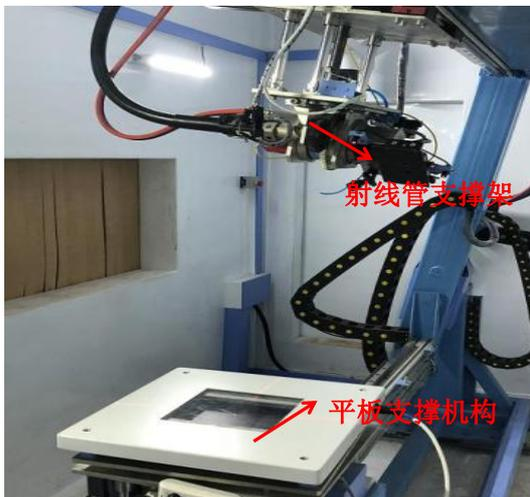
图 9-3 射线管支撑机构与平板支撑机构
