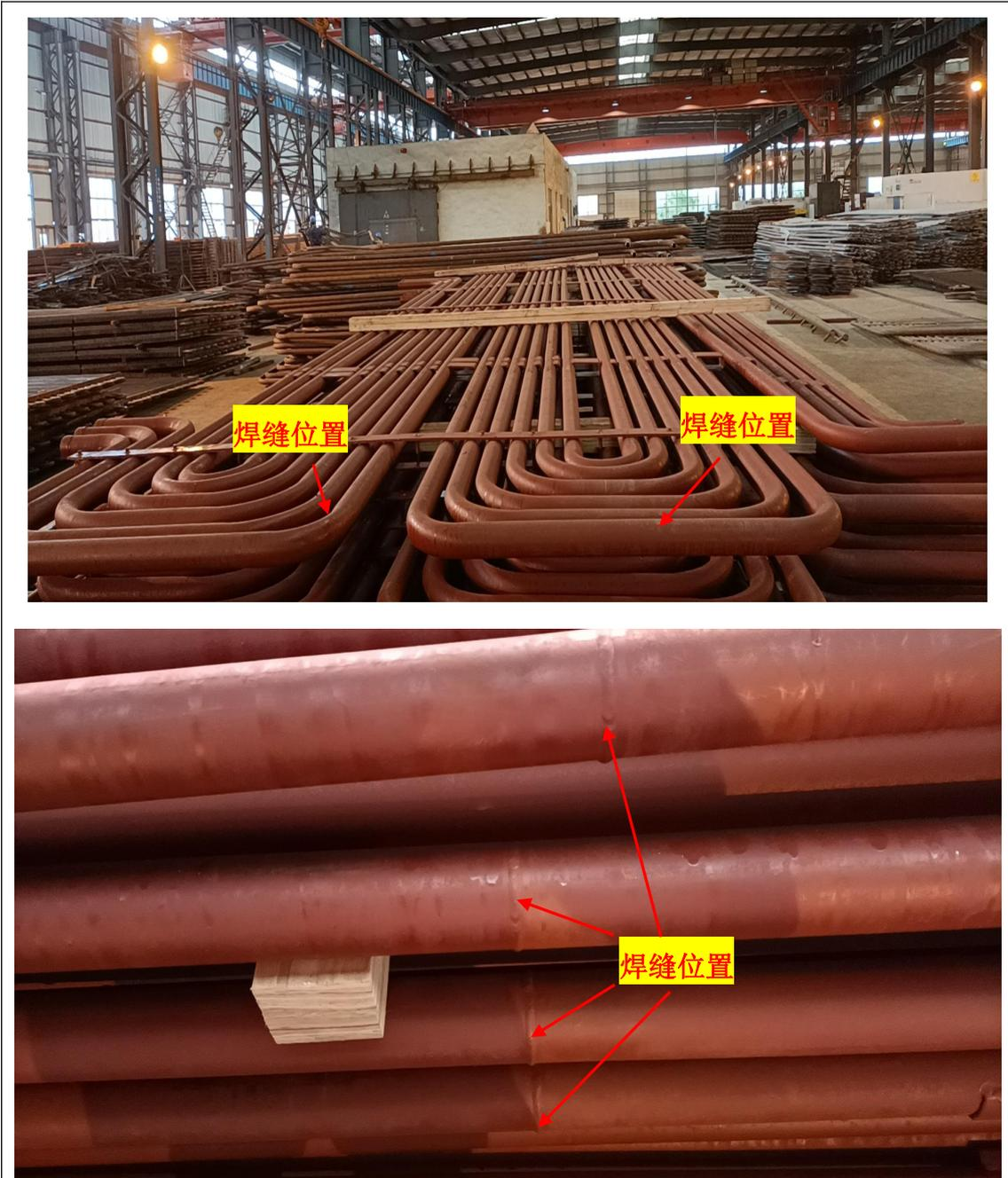
图 9-10 同类型探伤检测工件实景图
