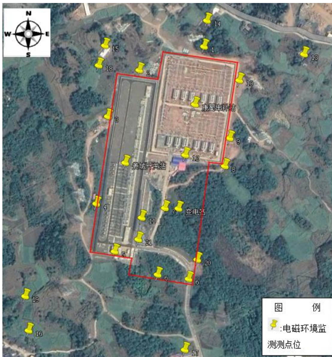
图 6-1 姜城开关站工频电磁场监测布点示意图
