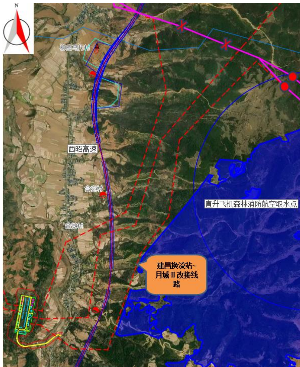
布拖换流站一期接入月城Ⅱ线路改接方案示意图
