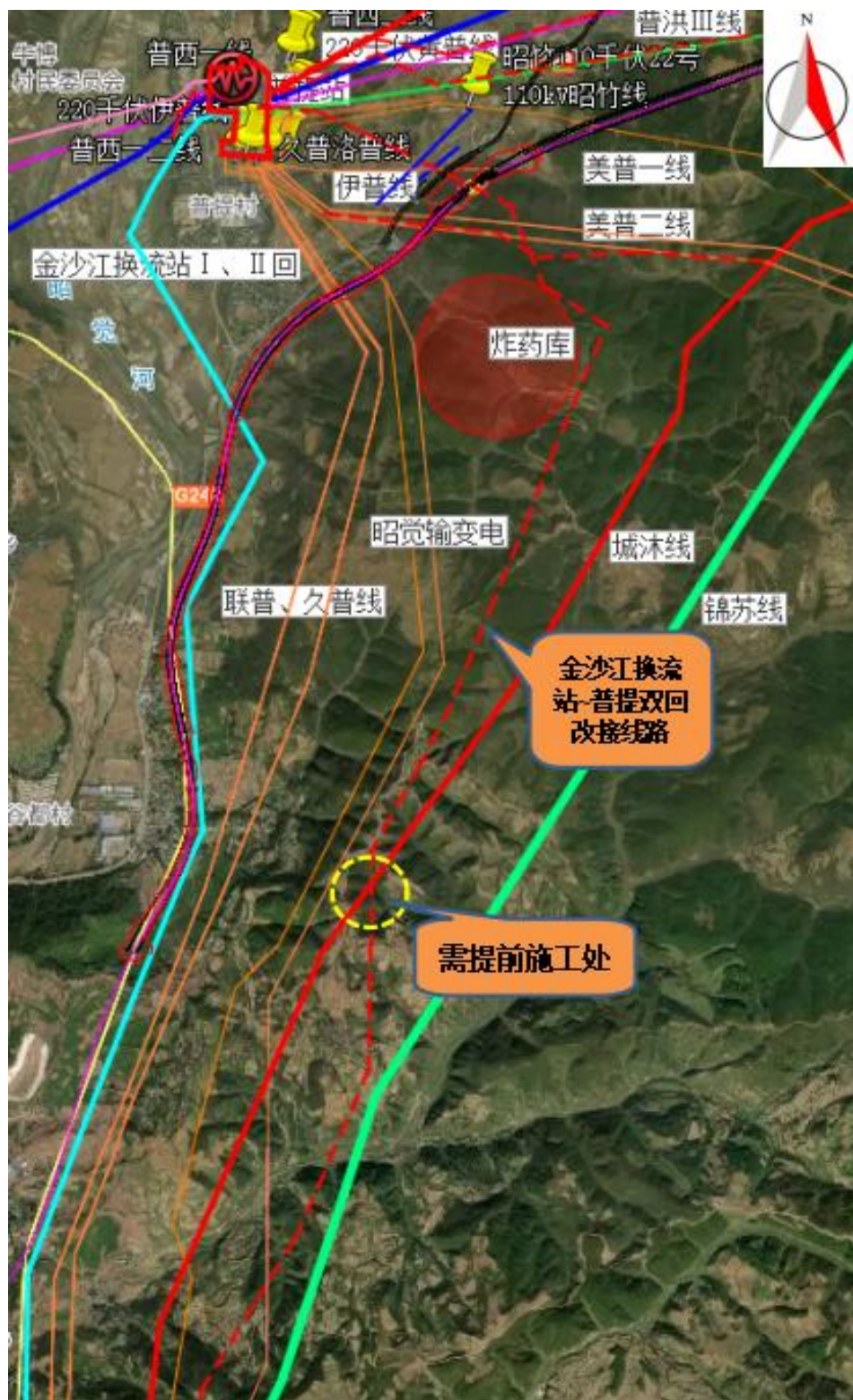
普提～布拖换流站二期改接线路方案示意图
