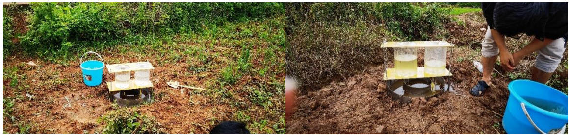
图 5.3-2 渗水试验现场工作照片
