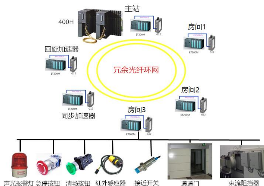
图 4.2-3 PLC 系统网络结构
