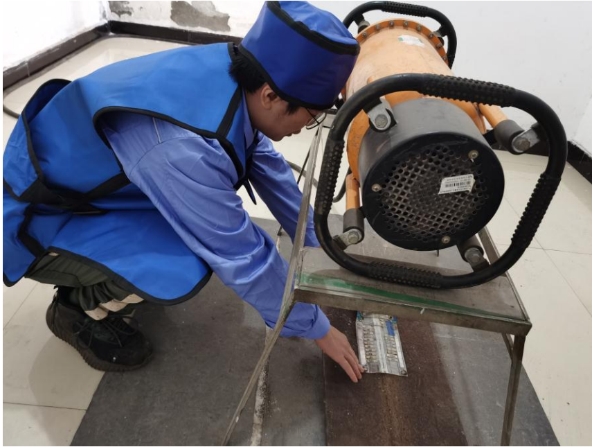
图 9-6 建设单位作业人员放置焊缝试板、试管方式示意图
