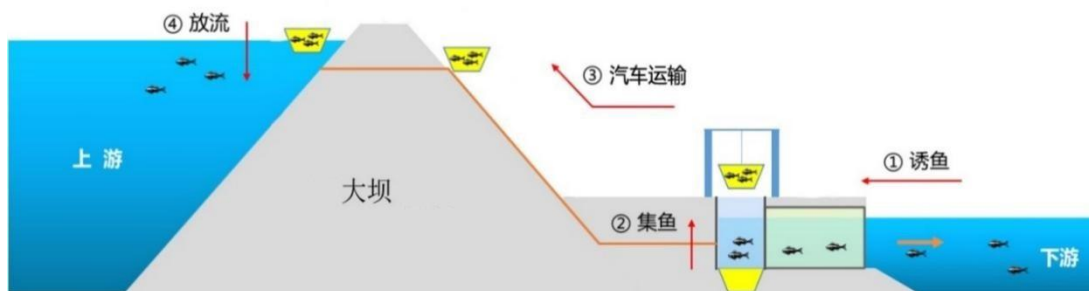
图7.8-2 集运鱼系统过鱼流程示意图
