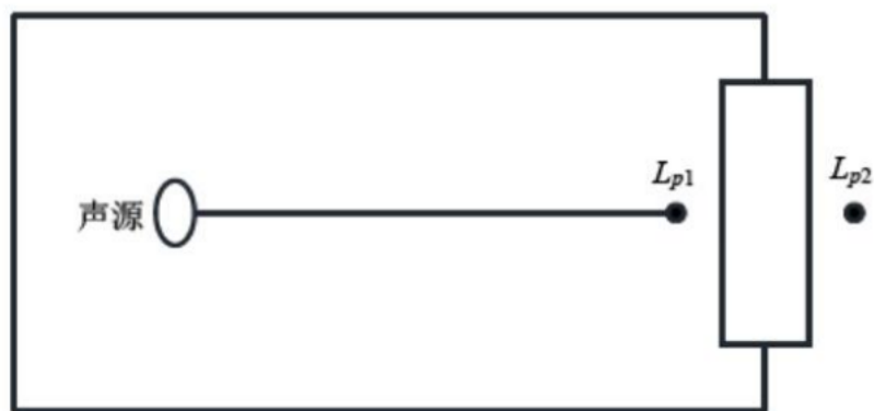
图 6.5-1 室内声源等效为室外声源图例
