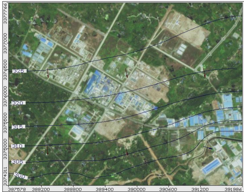
图 6.5-3 初始渗流场模拟结果图（单位：m）
