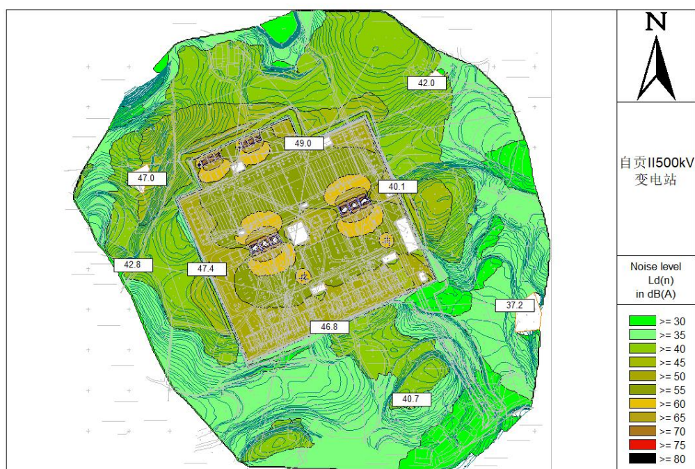
图 6-70 采取专项控制措施后自贡 II500kV 变电站噪声预测（贡献值）等声级线图
