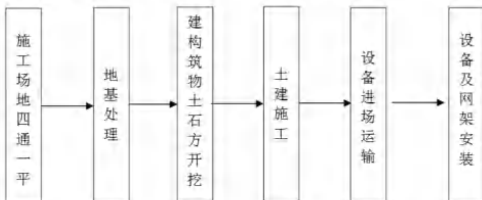
图 3.3-1 变电站施工工艺流程图
