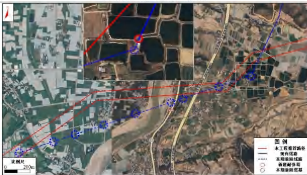
图 3.1-4 220kV 永昌线拆除改造工程示意图
