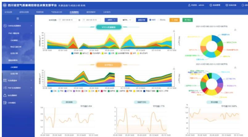
图 3-15 挥发性有机物溯源：逐小时测定 VOCs 化学成分、基于成分谱进行来源溯源
