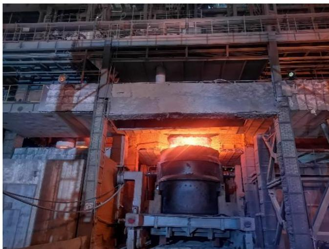
图 2-6 精炼炉无可见烟粉尘外逸
